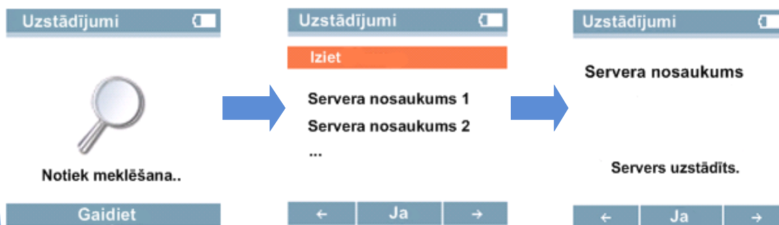
5. att. Veicamās darbības servera uzstādīšanai
